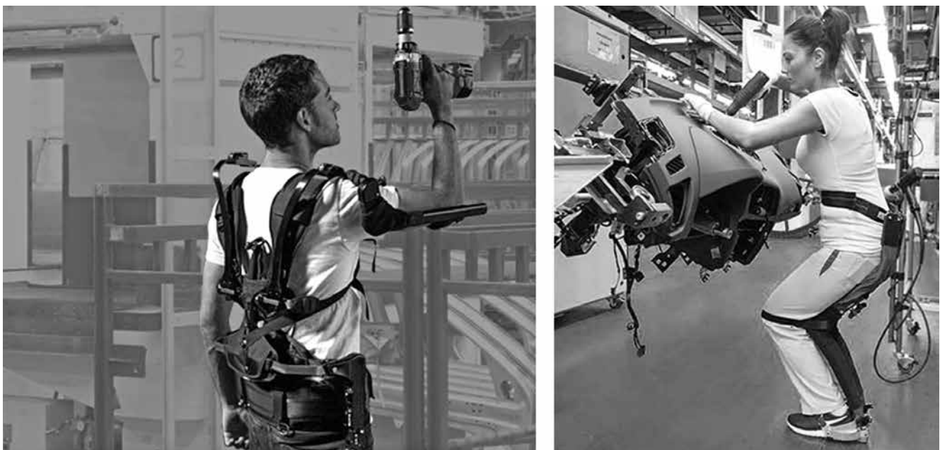
Fig. 3. Examples of exoskeletons supporting operators' ergonomics. Source: www.asme.org . Esempi di esoscheletri che supportano l'ergonomia degli operatori.
